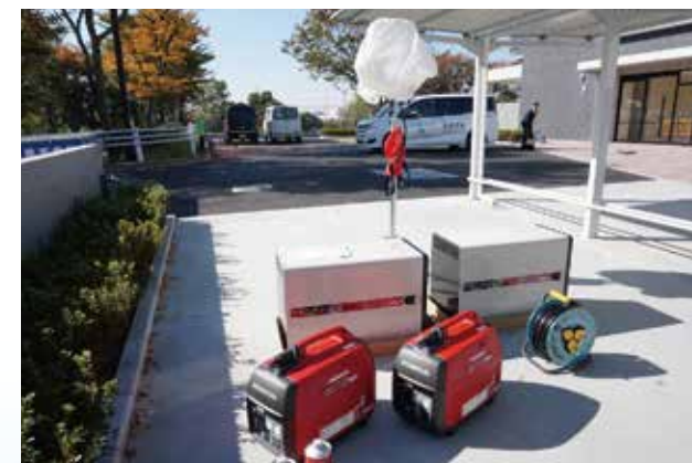
導入した可搬式発電機2台と投光器
